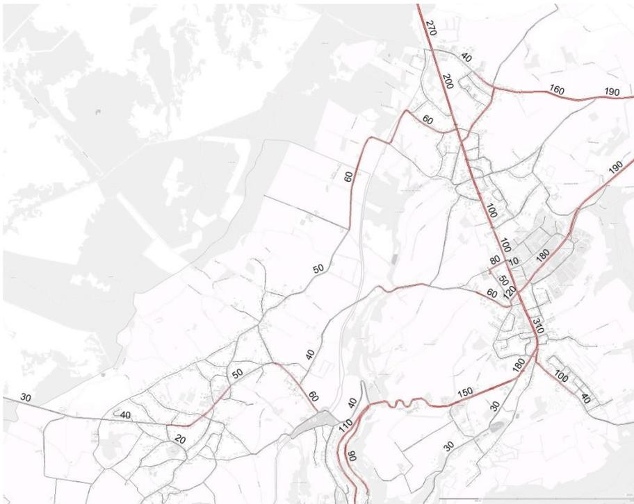
Abb. 2.3-5: Differenz Ist-Zustand 2019 und Nullprognose 2030 – Tagesaufkommen in DTVw (Kfz / 24h)
