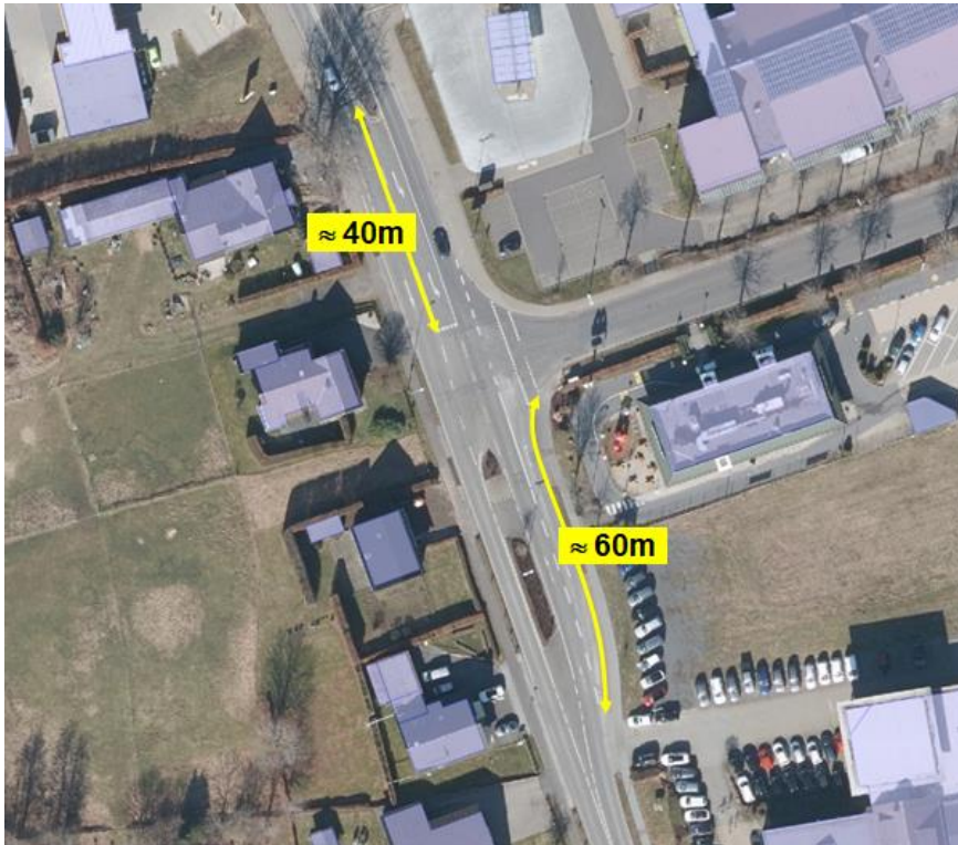
Bild 10: Vorfahrtgeregelte Einmündung „3“ auf der Trierer Straße B 258 (Quelle: TimOnline NRW)
