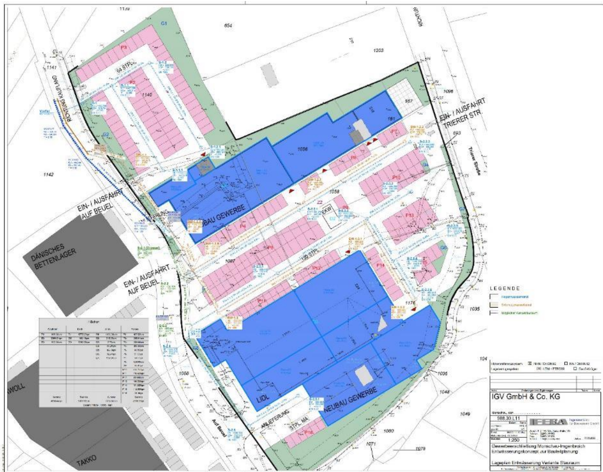
Abbildung 11 Lageplan Entwässerung Variante Stauraum
