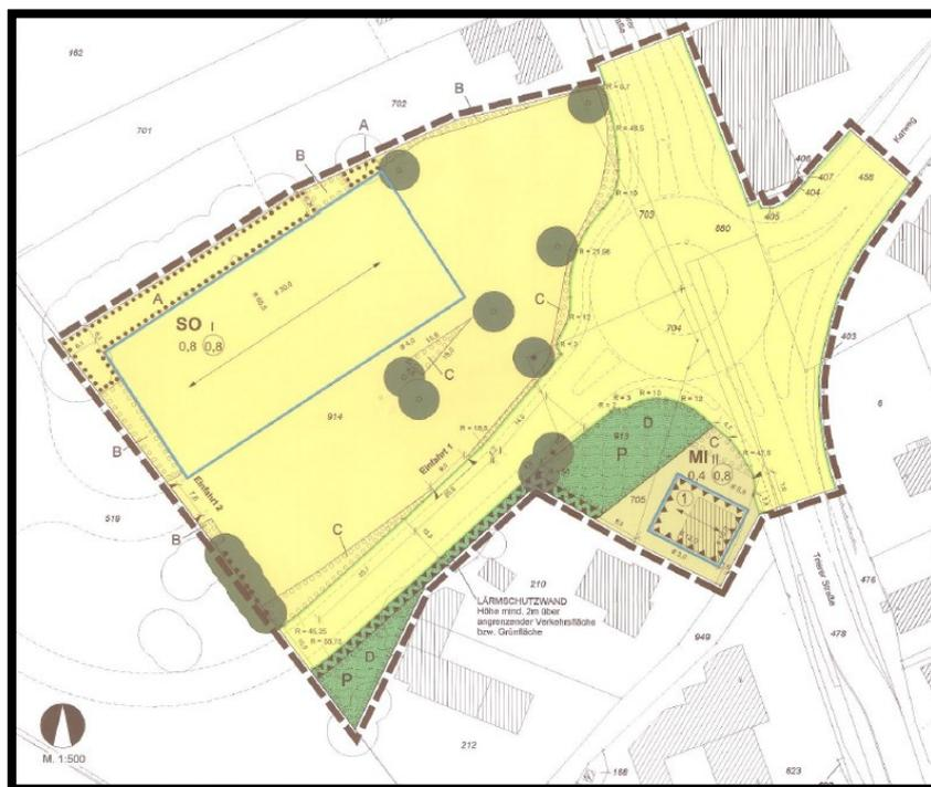
Abb.: B-Plan Nr. 12 – „Einzelhandel – Kreisverkehr-Zentrum“ mit Darstellung von Ausgleichsmaßnahmen (Einzelbäume und Flächen mit offenen Punkten) sowie Festsetzungen zum Erhalt (Flächen mit geschlossenen Punkten) – übernommen in Ursprungsverfahren Nr. 22.
