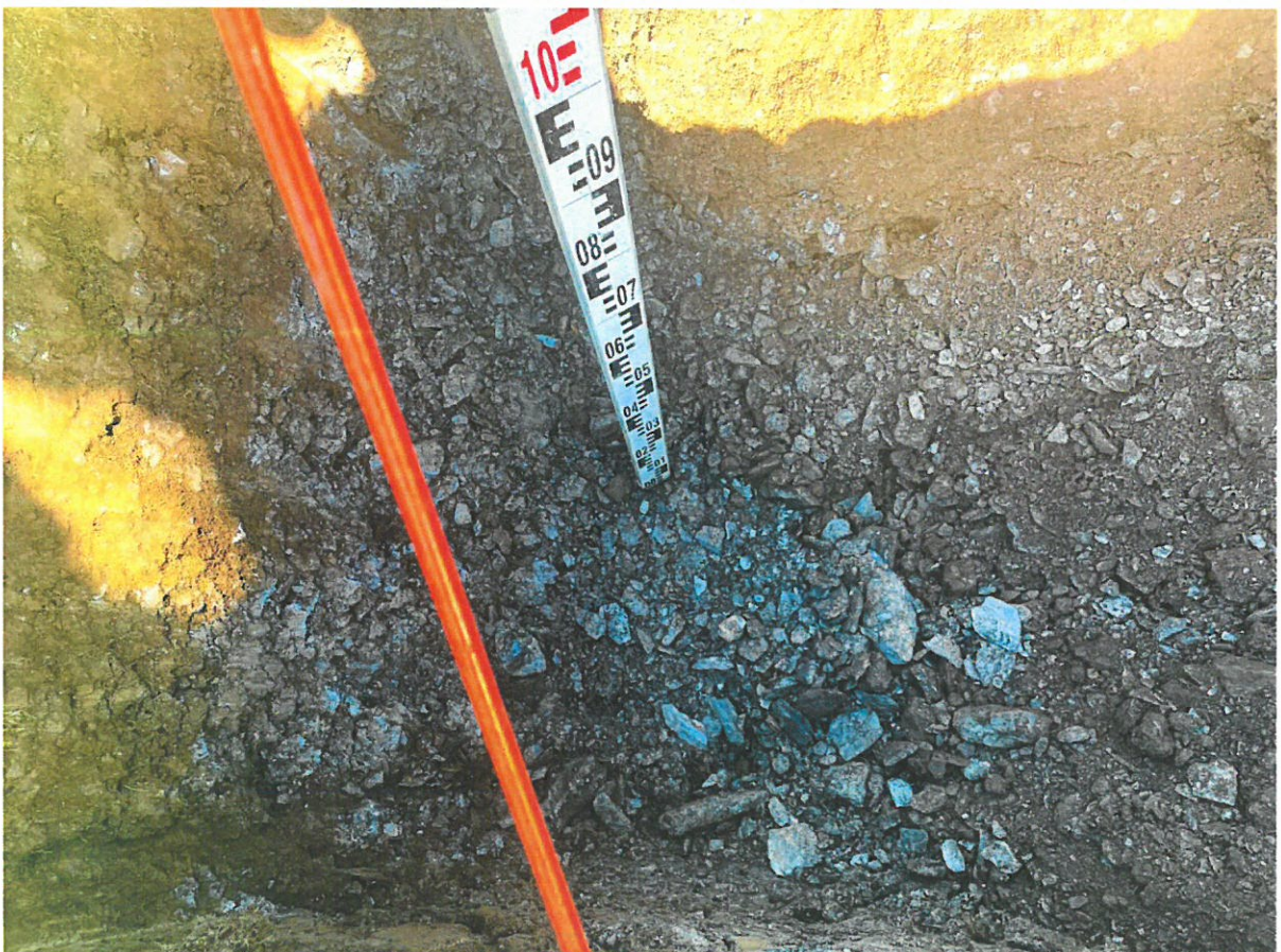
Bilder 5 und 6: Baggerstufung am 07.11.2025 mit ET = 1,0 m unter Flur, Baugrundsituation und Vorbereitung des Versickerungsversuchs
