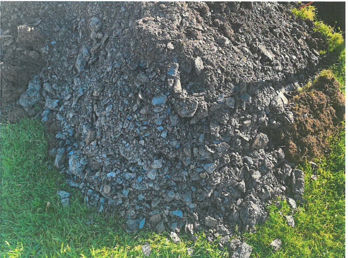
Bilder 3 und 4: Baggerschurf am 07.11.2025 mit Endtiefe t = 1,0 m und zugehörigem Aushubmaterial
