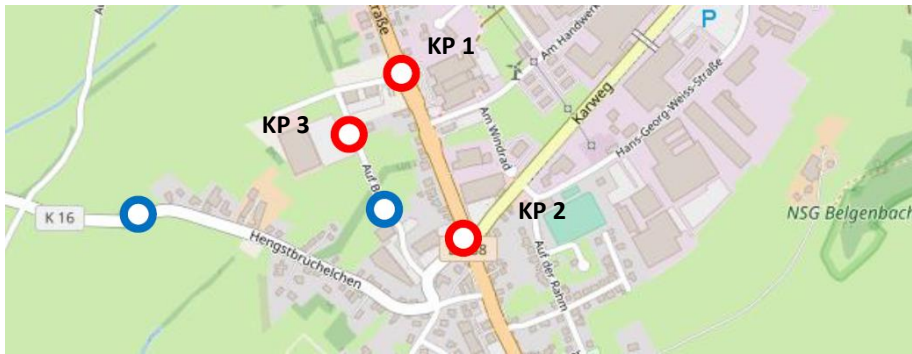
Abb. 2.1-1: Zählstandorte (blau: Querschnittszählungen, rot: Knotenpunktzählungen)
