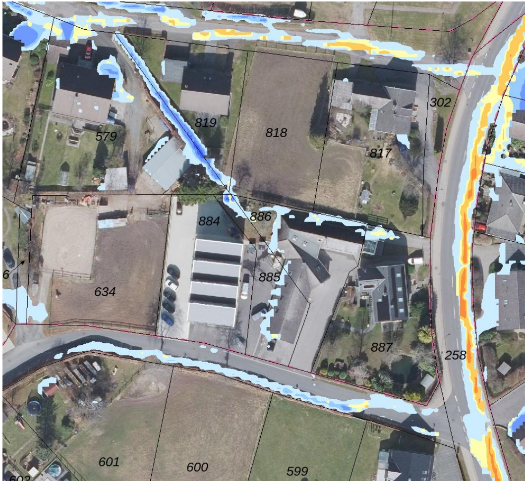
Abbildung 6: Auszug aus der Starkregengefahrenkarte (Geoportal NRW) für ein Extremereignis (90 mm/h)
